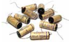
MP-Kondensatoren, zum Schutz vor Umwelteinflüssen mit Bitumen versiegelt.
