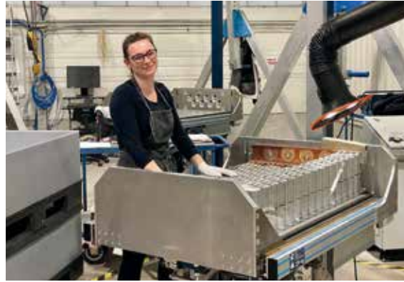
Der Zusammenbau der schweren Großkondensatoren ist nur noch mit besonderen Montagetischen machbar.
