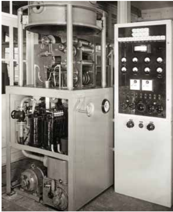
Vakuunkessel für die Öl-Imprägnierung von Papierkondensatoren.
