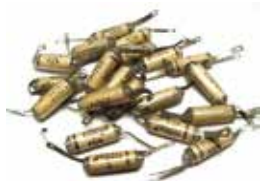
Styroflex. Als Dielektrikum diente hier bereits eine Kunststofffolie.
