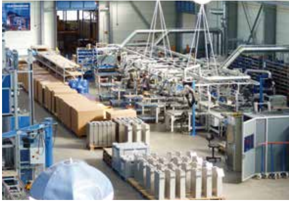
Volles Haus. Ein einziges HGÜ-Projekt verbraucht oft mehrere tausend, bis zu 260 kg schwere Großkondensatoren.
