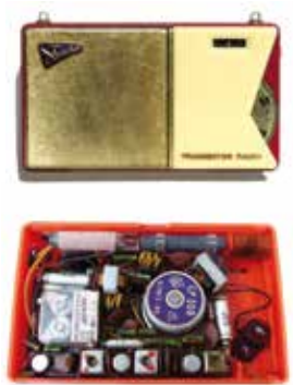
„Sternchen“, das erste ostdeutsche Transistorradio. Deutlich sind die drei Elkos aus Gera zu sehen. Allein 1959 gingen 200.000 Miniaturelkos in diese Geräte ein.
