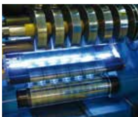
Mit der ELECTRONICON-Sine-CUT-Wellenschnitttechnik wird die Stromtragfähigkeit der Wickel weiter gesteigert.
