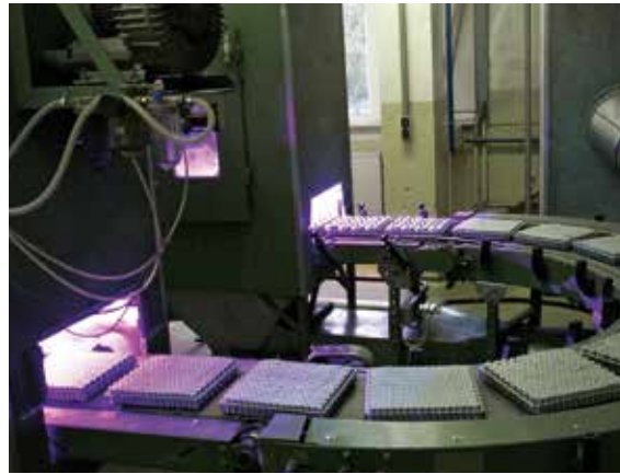
Diese Kontaktieranlage aus den 80er Jahren leistete treue Dienste bis 2004. Sie war für das sogenannte „Massensortiment“ effektiv, da sie in kurzer Zeit hohe Mengen an kleinen Wickeln verarbeiten konnte.
