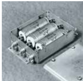
MP-Kondensatoren in einer Filterschaltung.
