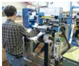
Drosseln mit kostensparenden Aluminiumspulen werden in Bandwickeltechnik gefertigt.
