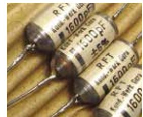
Styroflexkondensatoren gab es sowohl mit Metallfolien als auch bereits mit metallisierter Kunststoffolie. Die Grundlagen für letztere wurden 1946 bis 1948 gelegt.
