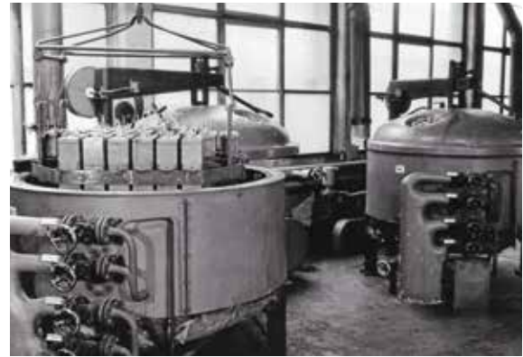
Vakuunkessel für die Öl-Imprägnierung von Papierkondensatoren.
